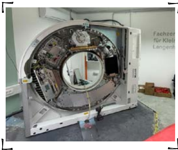
Abb. 4 | In der Gantry steckt eine Menge an Technik. Die Röntgenröhre rotiert um den Patienten.
